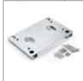
Podwyższona płyta fundamentowa. Zamocowana do podłoża 4 prętami Ø 11 w rozstawieniu osiowym 280 x 170, z zamocowaniem silnika 4 śrubami M10 w rozstawieniu osiowym 269 x 106
