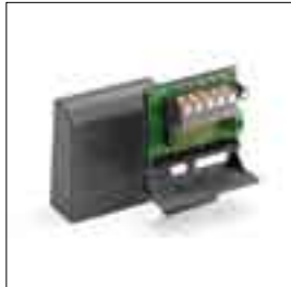
Karta elektroniczna, która umożliwia zsynchronizowany ruch 2 szlabanów
