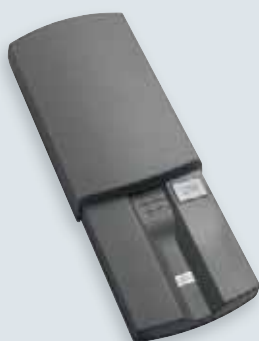
Radiowy czytnik linii papilarnych FFL 12 przeznaczony na maksymalnie 12 indywidualnych odcisków palców. Programowanie odcisków palców wykonuje się wygodnie bezpośrednio na czytniku.
